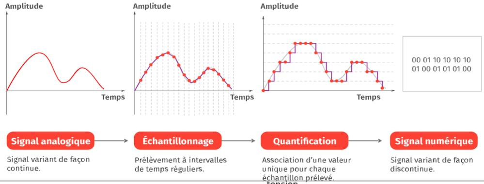
**1- Echantillonnage :** On relève à intervalle de temps régulier  $T_e$  la valeur du signal analogique.
