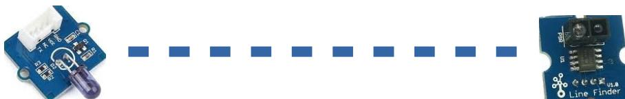
Information : Faisceau coupé (détection de passage) → Le signal du capteur suiveur de ligne sur le port D3 est à l'état HAUT = 1
