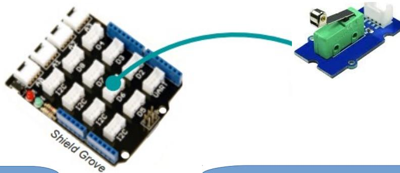
L'interrupteur fin de course se connecte sur l'un des ports numériques D2 à D8
