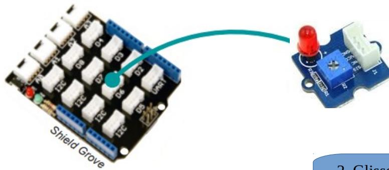
La LED se connecte sur l'un des ports numériques D2 à D8
