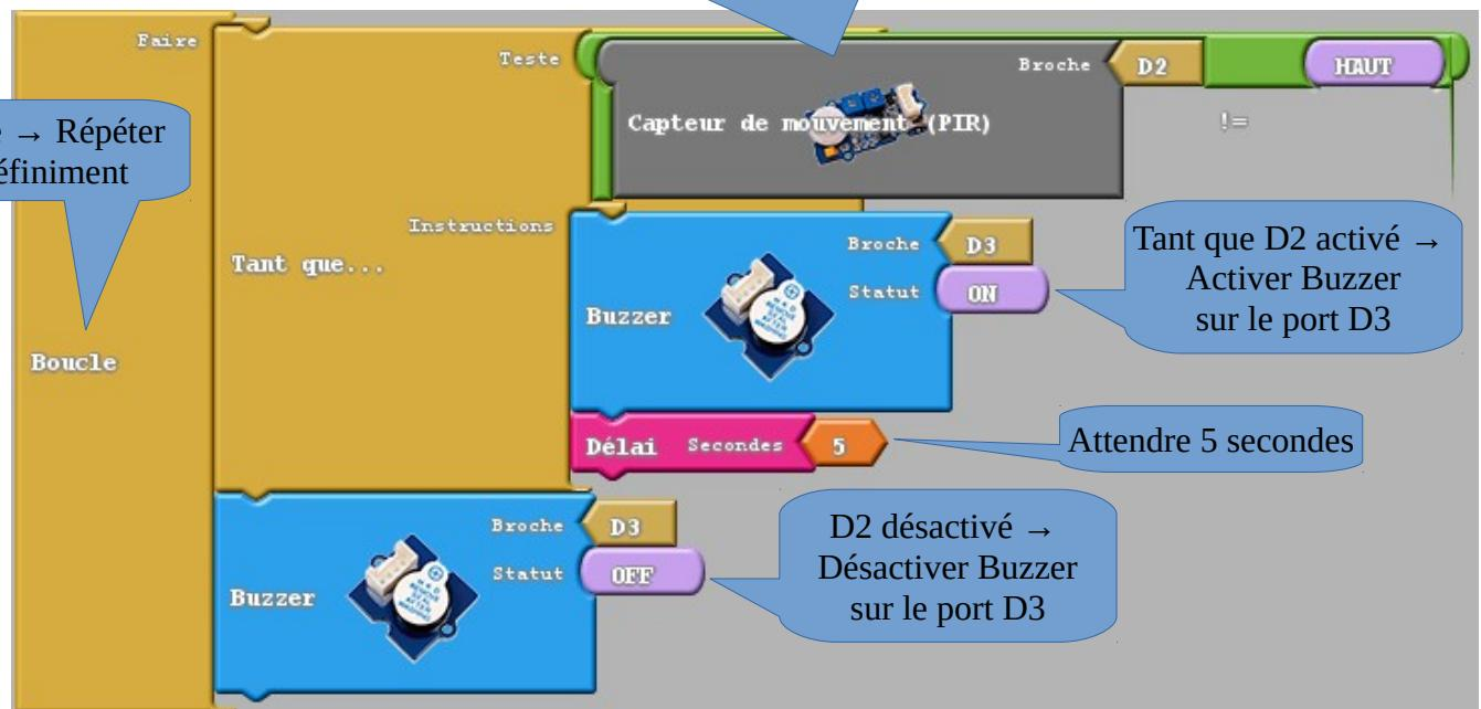
**Remarque :** Le détecteur de mouvement volumétrique (PIR) est capable de détecter le rayonnement infrarouge de toute personne ou animal passant à sa portée (10 cm à 6 m maxi) ; avec un angle de 120°.
