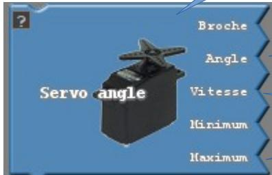
Contrôle un servomoteur en spécifiant un angle → Valeur de 0 à 1023
